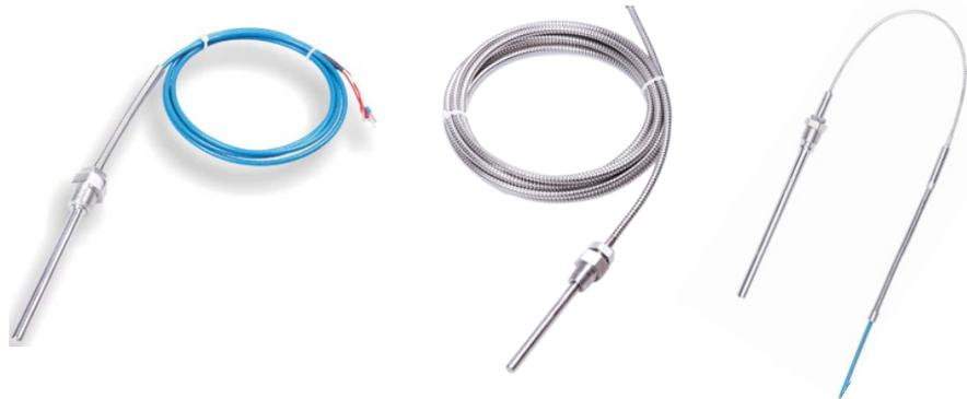
TPS温度传感器用于温度测量的传感器，通常用于工业显示仪表或电子调节器配套使用，可以直接测量各种生产过程中的液体、蒸汽和气体介质以及固体表面的温度。芯片式感温元件，采用激光焊接技术，防止在强烈振动的场合下焊点松动或脱落，有效地提高了测量的稳定性。耐油耐高温屏蔽导线，护套层及绝缘层采用特殊聚合物制作而成，可以在100℃的油温中长时间工作；紫铜镀银的芯线具有良好的导电性能，每百米的均衡度小于0.05Ω。
