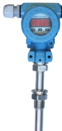
TPC温度变送器，表头显示温度，将温度信号转换成4~20mA标准信号，实现远距离传输和计算机监控，适用于测量各种液体、蒸汽和气体介质以及固体表面的温度。
